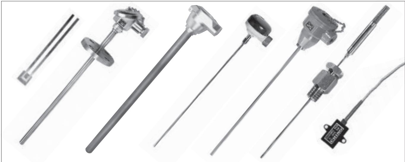
産業計測用、一般計測用として多く使用されている温度センサは、熱電対と測温抵抗体です。熱電対と測温抵抗体は、温度によって変化する電気的な量を測定するもので、熱電対は熱起電力を利用し、測温抵抗体は、電気抵抗の変化を利用しており、受信計器（記録計、調節計、指示計など）
