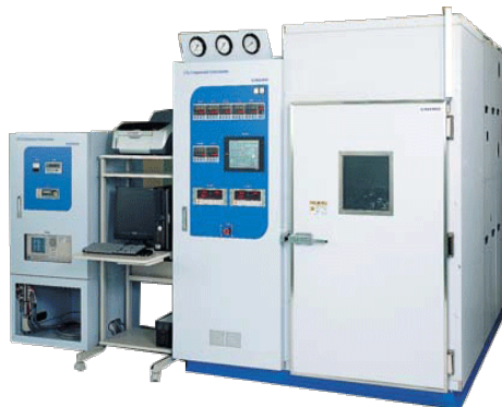
コンプレッサ 性能試験装置
