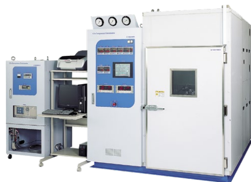
コンプレッサ性能試験装置
