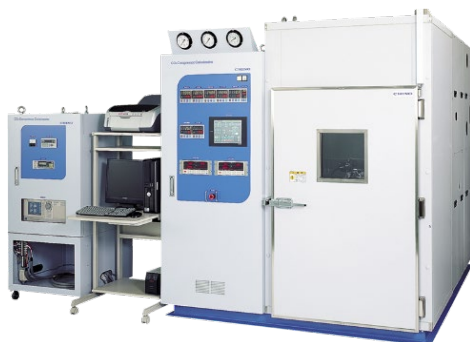
コンプレッサ 性能試験装置
