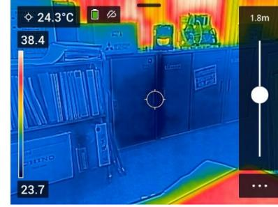
※ MSX選択時に輪郭がずれて表示される場合は、MSXの距離設定を変更してください
