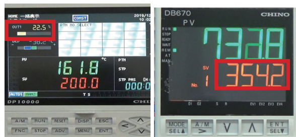
1次調節計 2次調節計 1次調節計のMVと2次調節計のSVが連動して動く。
